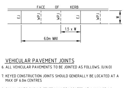
8. SAWN JOINTS SHOULD GENERALLY BE LOCATED AT A MAX OF 6.0m CENTRES WITH DOWELED EXPANSION JOINTS AT MAX 18.0m CENTRES
